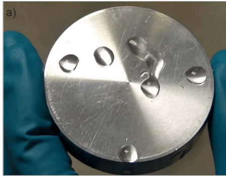
Figure 1- a) Photo d'un substrat brut d'aluminium non-microstructuré t b) Photo d'un substrat brut d'aluminium microstructuré par laser impulsionnel (MANUTECH -USD)
